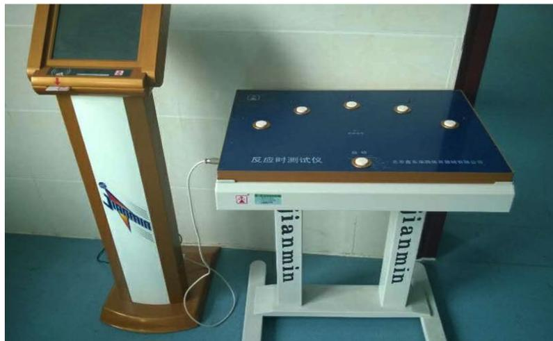
Рисунок 5 - Общий вид устройства для регистрации двигательных реакций.
