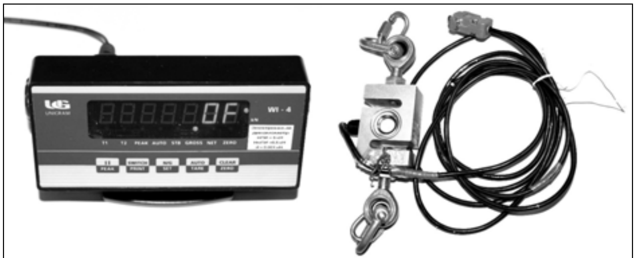
Рисунок 2.8 - Электронный динамометр: Слева – измерительный прибор, справа – тензодатчик
