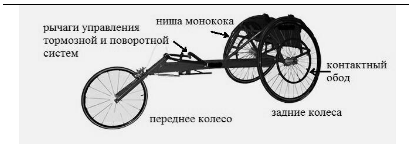
Рисунок 8 - Схема беговой легкоатлетической коляски спорта лиц с поражением опорно-двигательного аппарата
