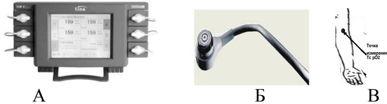
Рисунок 6 – Внешний вид TCM-400 «Radiometer» (А); датчик с мембранным закрытым электродом (Б); точка измерения (В)
