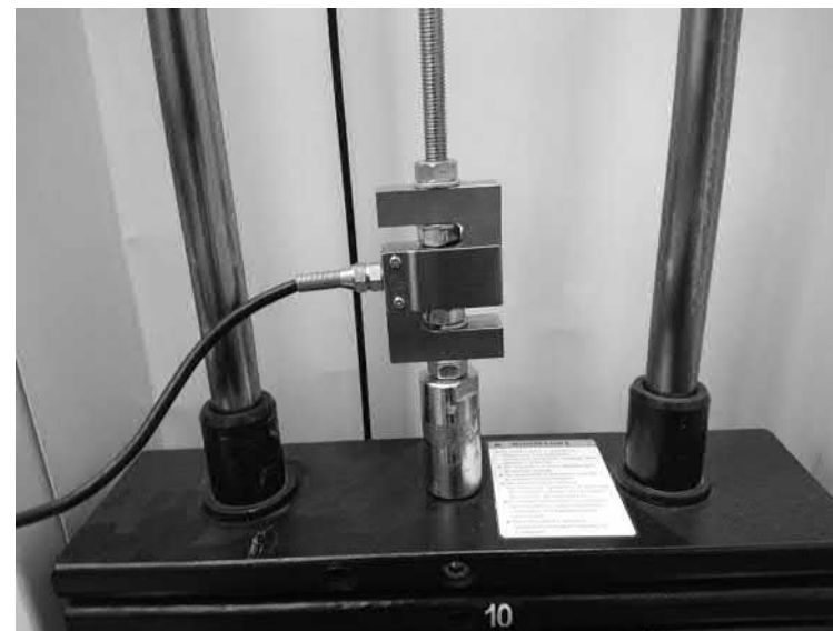
Рисунок 1 – Образец конструктивного решения системы регистрации усилий на грузоблочном тренажёре
