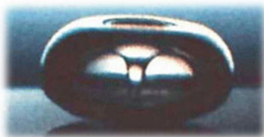
Рисунок 1 – Кавитационный пузырек в момент взрыва [1]
